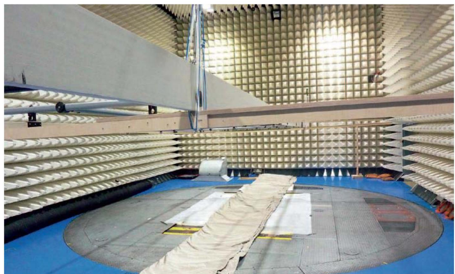
Abbildung 3: Stripline (1) mit Auslegern(2) und ausgerolltem Zelt (3) von Infracron.
