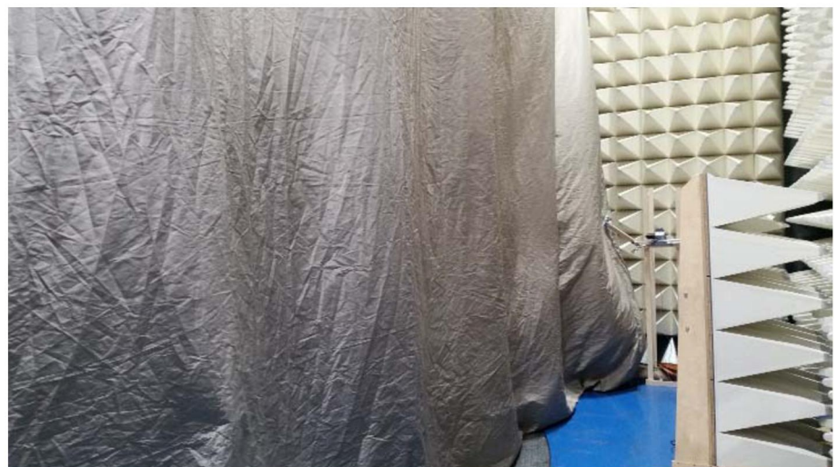
Abbildung 5: Nach dem Prinzip der VIRC sorgt eine simple Schwingungsvorrichtung für eine Verwirbelung der Moden durch Schwingungen an Kanten des Zeltes: Ein Scheibenwischermotor (1) regt die Wände über einen Hebelarm zur Schwingung an.
