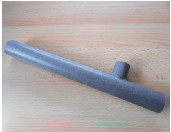
>>10: Komposit-Bauteil aus leitfähigem Textil und Glasfaser mit Thermoplast (Bilder: Infracron GmbH)
